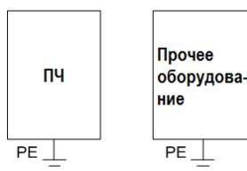
Для заземления используйте провод достаточного сечения, чтобы уменьшить сопротивление линии заземления;
