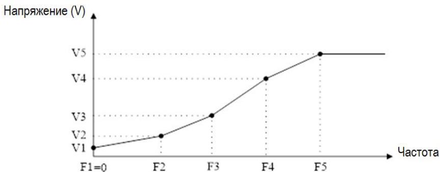
P1-53 / P1-55 / P1-57 / P1-59 / P1-61 соответствует  $V_1 \sim V_5$ , а P1-54 / P1-56 / P1-58 / P1-60 / P1-62 соответствует  $F_1 \sim F_5$ . Приведенные ниже правила должны соблюдаться для набора:  $F_1 = 0$  и  $F_1 \leq F_2 \leq F_3 \leq F_4 \leq F_5$ . При необходимости вы можете объединить две или более точек в одну, чтобы упростить V/F кривую, например, как показано ниже:
